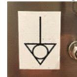
Utilizado para garantir que não haja diferença de potencial entre os diferentes equipamentos ligados a rede elétrica, diminui significativamente os riscos de choques elétricos; Cada equipamento elétrico deve ser ligado um ao outro pelos seus respectivos terminais de ligação equipotencial;
